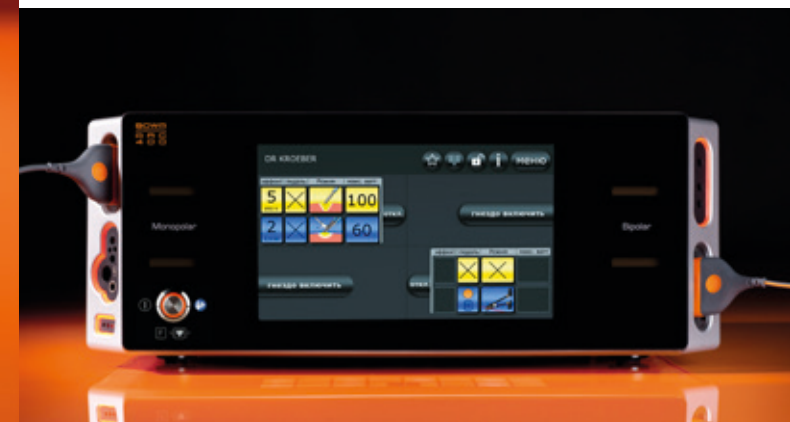
Понятность: каждый подключенный разъем – на изображении верхний левый и нижний правый разъемы – соотношен с одним квадрантом экрана
