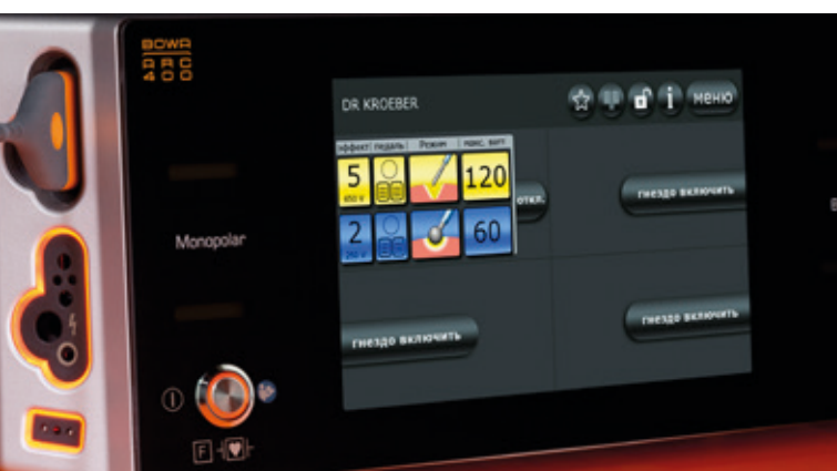
Plug'n Cut: ARC 400 автоматически распознает, когда подключается стандартный инструмент
