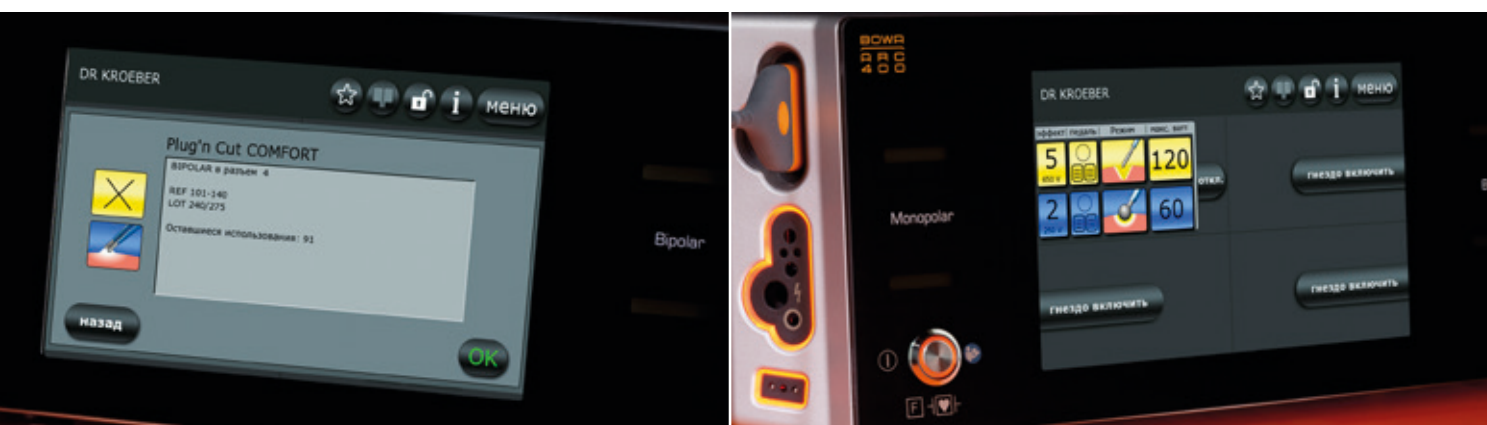
Plug'n Cut COMFORT: система COMFORT автоматически распознает инструмент, информирует о том, сколько раз может быть еще применен этот инструмент и выбирает параметры, необходимые для цели применения.
